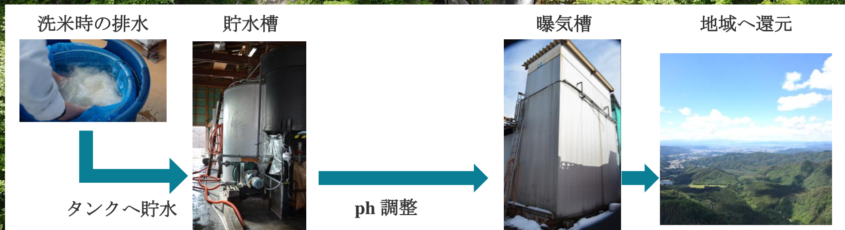
Fig. 小嶋総本店の排水処理工程
